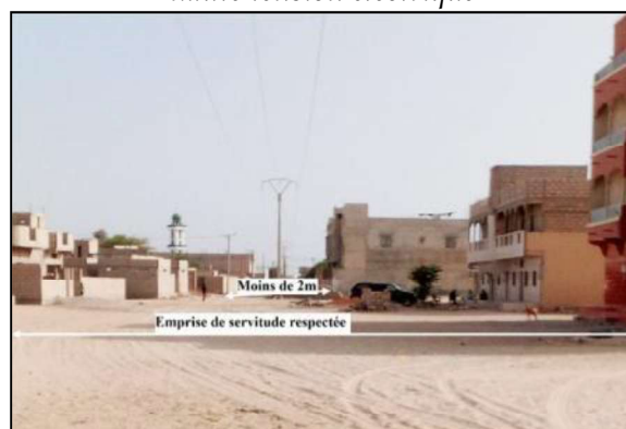
Non-respect de l'emprise de servitude de la haute tension par les habitations
